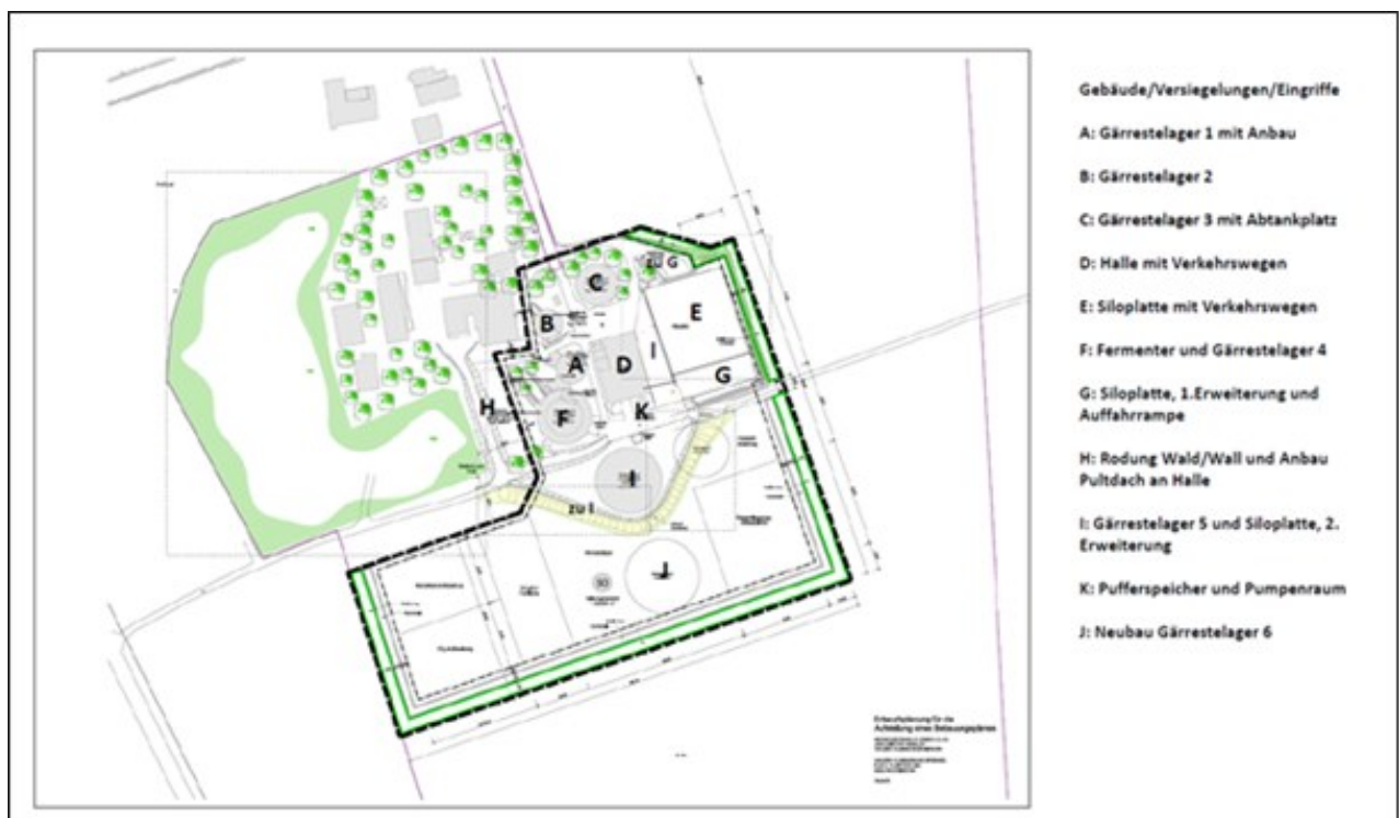
Abbildung 2: Lageplan der einzelnen Anlagenbestandteile der bestehenden Biogasanlage (Plangrundlage: Planwerk.Agrar GmbH von 2023, bearbeitet)
